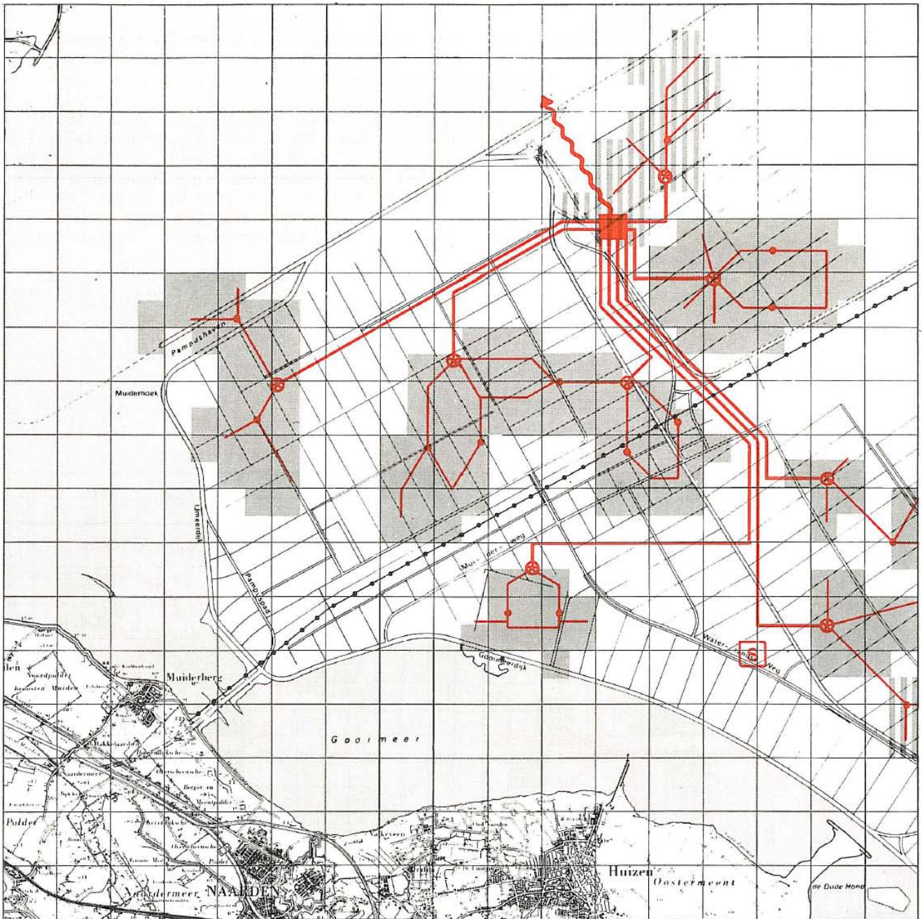
Figuur 45. Vuilwaterriolering Almere (wijkriolering weggelaten)
